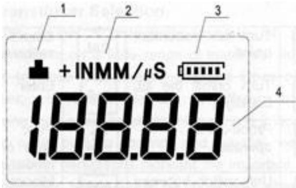
1 Indique le statut d'accouplement. Lors d'une une mesure, le statut d'accouplement doit être allumé., sinon l'appareil aura des difficultés à réaliser une mesure, et la valeur d'épaisseur affichée sera très probablement incorrecte. 2, unité : Système d'unité courante. Millimètre ou Inc pour la valeur d'épaisseur. M/S ou Inc/S pour la vitesse
