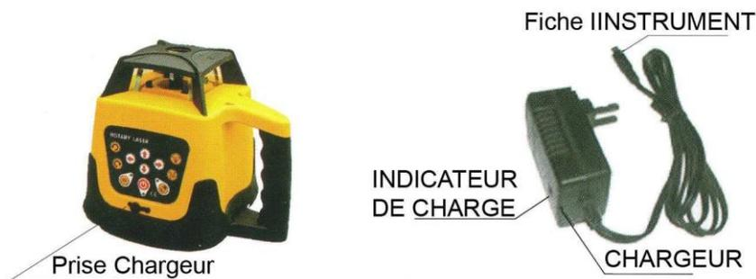
Quand les voyants de signalisation de tension sont allumés, les batteries doivent être chargées immédiatement. En reliant le chargeur au C.A., insérer la prise de chargeur dans le trou de prise au fond de l'instrument (comme représenté ci-dessus).
