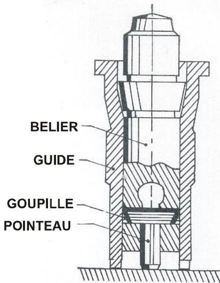
Il consiste en un manche extérieure et d'un ensemble testeur. Avant chaque test une goupille calibrée est insérée dans le béliier. Le béliier doit être ensuite positionner dans le guide.
