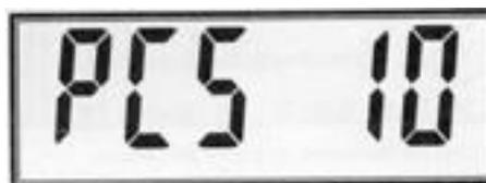
Pressez « UNIT » pour vérifier le poids unitaire et le poids total, la balance revient après en mode de comptage simple.
